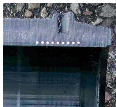
Рис. 3. Разрез — закрытая нагревательная спираль.
